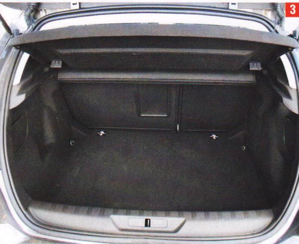
3. Багажник не самый большой (470 л), но имеет низкую погрузочную высоту, хорошую форму без всяких выступов, а в спинке заднего сиденья есть люк для погрузки длинномеров
